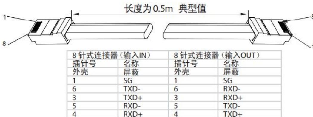
图 7-6: 带有 RJ-45 屏蔽连接器的串行环线
